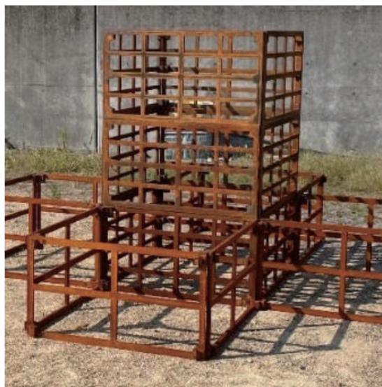
ダクタイトル鋳鉄は、鋳鉄にマグネシウムやレアアースを添加し、金属組織を球状化することで強度としなやかさを兼ね備えた素材です。その優れた耐久性と耐腐食性により、下水道のマンホール鉄蓋など幅広い用途で使用されています。
