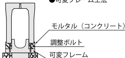
●可変フレーム高さ調整ボルトタイプ
