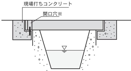
※ズレ止め差し筋用の開口穴加工もできます。
